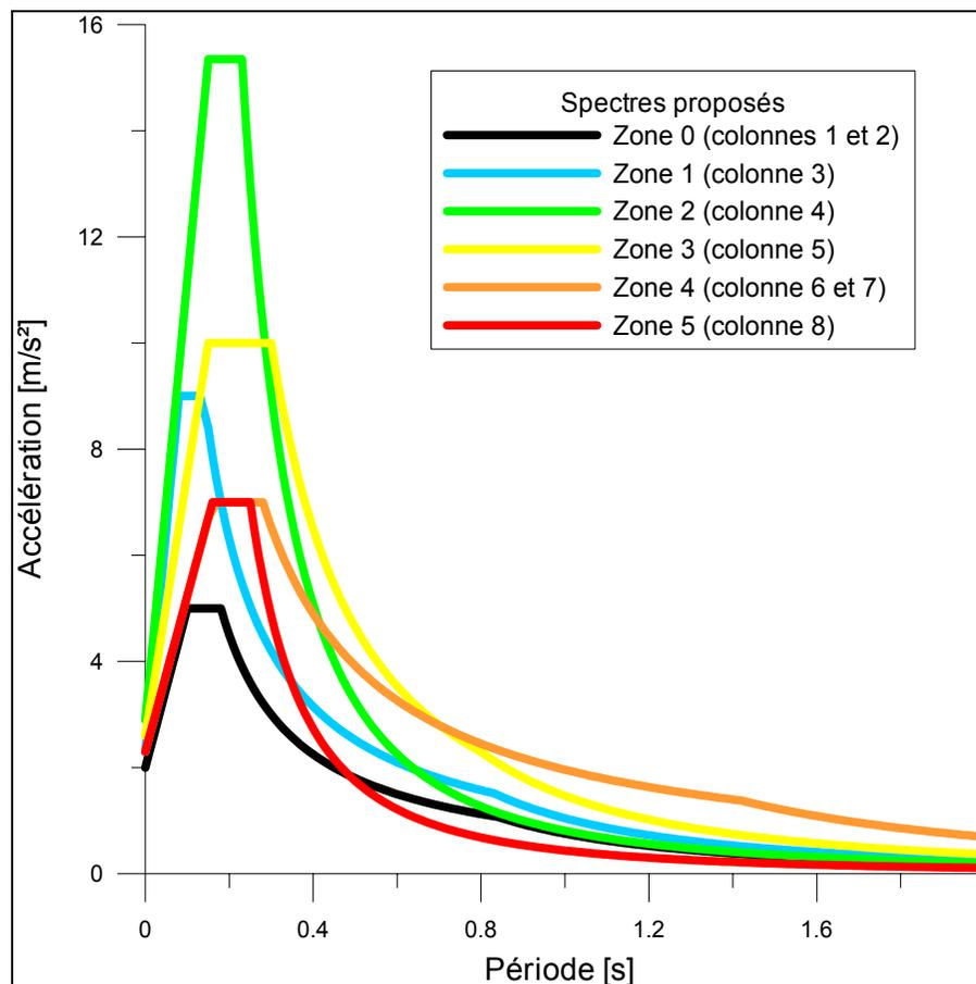
Figure 1 - Spectres des 6 zones du microzonage
