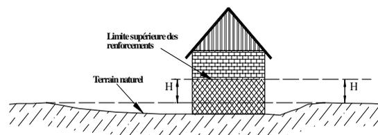
**En cas de terrassement en déblais**, la hauteur doit être mesurée par rapport au terrain naturel initial.
